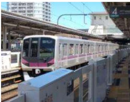
08 系は営団地下鉄が製造した車両である。2003 年に登場した。東武直通開始による輸送力増強をするために製造された。10 両編成が 6 編成導入された。ちなみにこれが営団地下鉄が開発した最後の新形式である。登場当時の前面と側面の行き先表示は 3 色 LED で、またドア上部にはスクロール式のものも設置されていたが、2014 年から、前面と側面の行き先表示はフルカラーLED に変更され、またドア上部は液晶ディスプレイに交換された。
