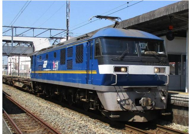
電気機関車だ。平坦区間で 1300t の貨物を 95km/h で牽引する力を持っている。最高時速は 110km/h で「ECO-POWER 桃太郎」という愛称がつけられている。また番台いくつかあり、マイナーチェンジ版の 100 番台、瀬野八専用補機 EF67 を置き換えつつ本務機にもなれるようにした 300 番台がある。写真は 300 番台（※補機・補助機関車・本務機・メインで引っ張っている機関車 ※瀬野八・八本松駅～瀬野駅間のこと、この区間は勾配が急で貨物列車が走れないので補助機関車を連結して走行している）
